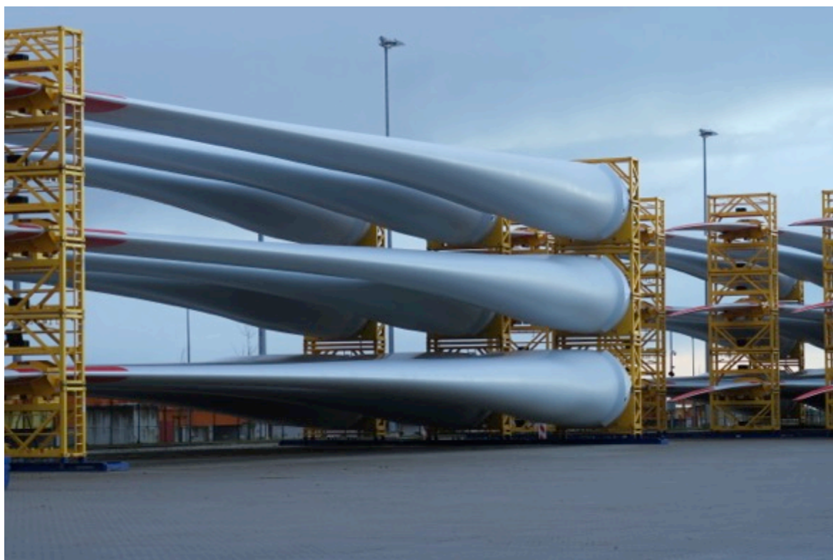
洋上への搬出を待つブレード(風車の羽)
